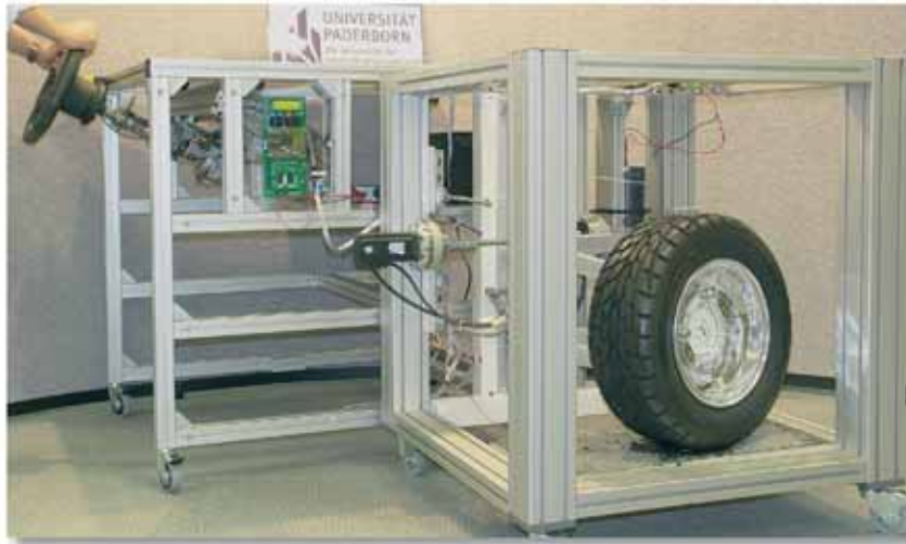
Bild 8: Steer-by-Wire Validator des C-LAB
