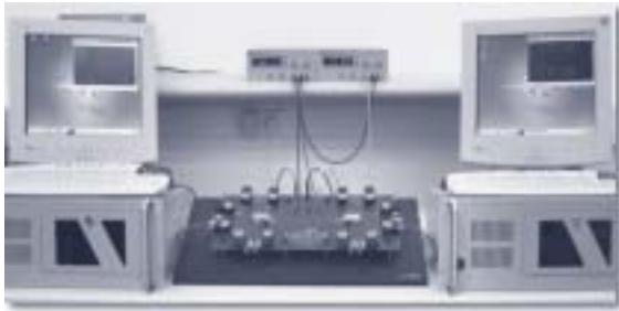
Bild 20: Demonstrationsaufbau einer Gigabit-Ethernet-Verbindung zwischen zwei Rechnern über opto-elektrisches PCB (vgl. Bild 21)
